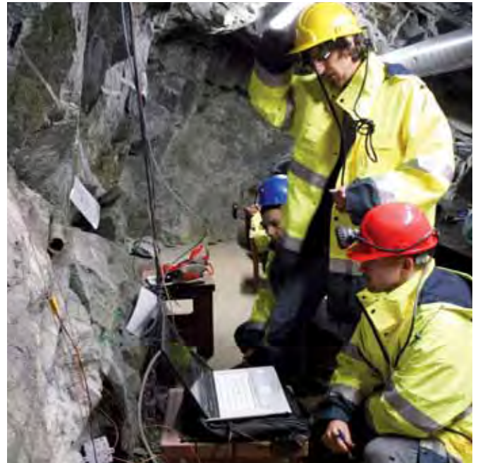
Student Michal Vittek měří ve štolě prostup tepla horninou pro bakalářskou práci.
