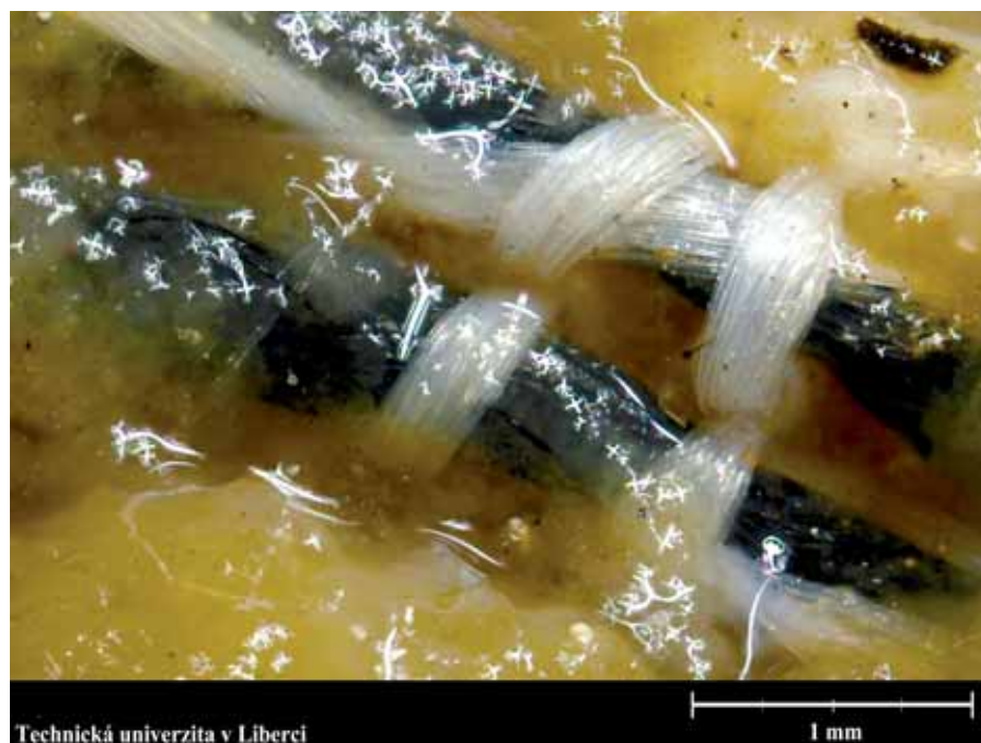
Detailní pohled na vlhký nanovlákný nosič, biofilm prorůstá jednotlivé nitě.
