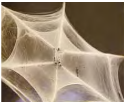
Nanovláknenná vrstva na univerzálním rámu demonstruje možnosti depozice a orientace nanovláken na speciálních kolektorech.
