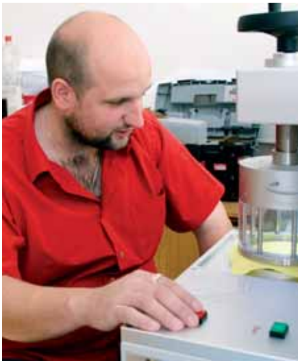
Roman Knížek měří hydrostatickou odolnost textilie s nanomembránou opatřenou speciálním filmem. Měření prokázala, že hydrostatická odolnost je podstatně vyšší.
